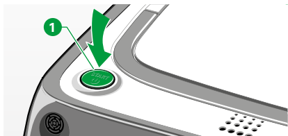
Obr. 4.8 Stlačenie tlačidla ŠTART robotického vysávača na prepnutie do pohotovostného režimu
