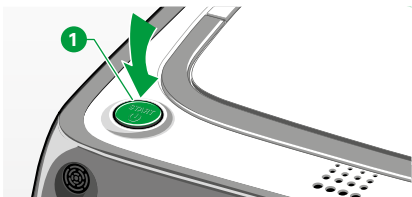
Фигура 4.8 Натиснете бутона START на прахосмукачката-робот за режим на изчакване
