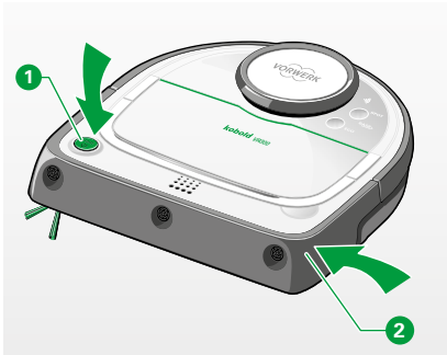
Slika 5.2 Odstranjevanje sesalnega robota iz omrežja
